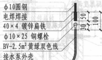
等电位接线端子联接大样图
